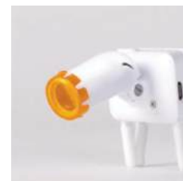
Световой фильтр предохраняет композиты от полимеризации
